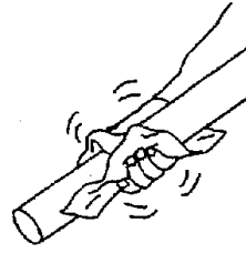
③ アルコールでふいた塩化ビニルの管をティッシュペーパーでよく摩擦する。
